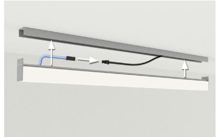
9. **Bei Leuchten in Linie:** Weitere Clips jeweils erst mit Montagehilfe verbinden und Schritte 1, 3 und 7 wiederholen. Leuchte und Clipprofil versetzt einclippen.
