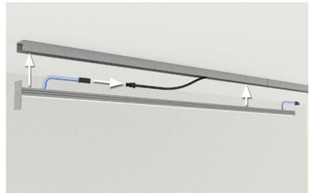
11. **Bei Leuchten in Linie:** Abdeckungen analog zum Montageclip einclippen.
