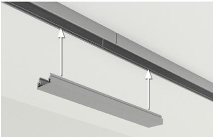
10. **Bei Leuchten in Linie:** Randleuchte an Anschlussleitung anschließen und festclippen. Weitere Leuchten kontaktieren und einclippen.
