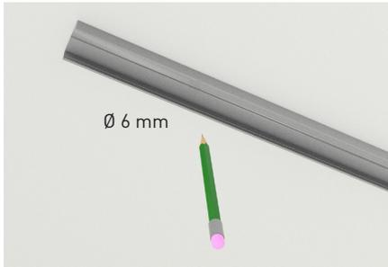
2. Loch für die Anschlussleitung bohren, bei Bedarf von innen mit 4er Bohrer vorbohren.
