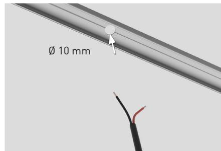
5. Offenes Leitungsende an das Vorschaltgerät bei 24 V polrichtig anschließen.
