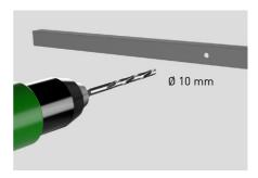
2. Löcher für die Schraubenbefestigungen in den Clip bohren.
