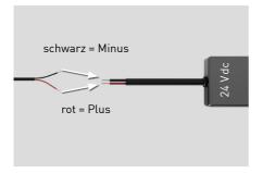
6. Vorschaltgerät mit Netzkabel verbinden.
