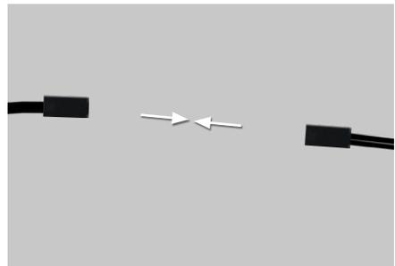
6. Offenes Leitungsende an das Vorschaltgerät bei 700 mA polrichtig anschließen.
